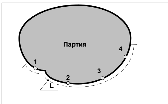
Рисунок В2 Расположение КТ вдоль доступной для выполнения измерений части периметра партии с длиной L
